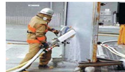
【消防防災科学技術研究推進制度の研究 成果(高水圧駆動カッター)】
